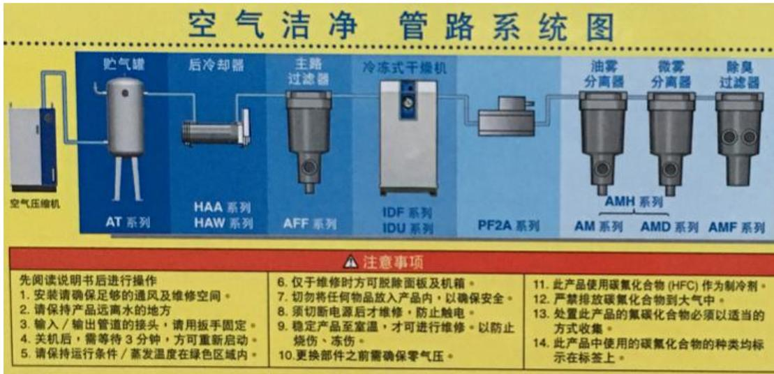
SMC 冷式干燥机分为 IDF 型（标准型）和 IDU 型（高温型），讲简单点就是 IDU 型比 IDF 型处理的压缩气体温度要高，因此如何选用可节约成本又能满足现场使用要求。
